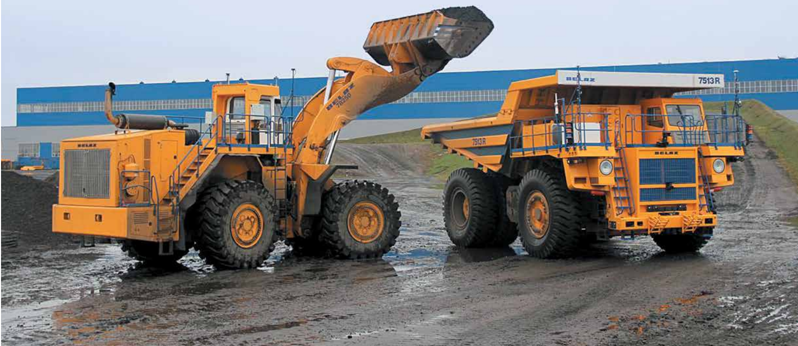
Роботизированный карьерный самосвал БЕЛАЗ-7513R и дистанционно управляемый погрузчик БЕЛАЗ-78250 проходят испытания на полигоне ОАО «БЕЛАЗ»
