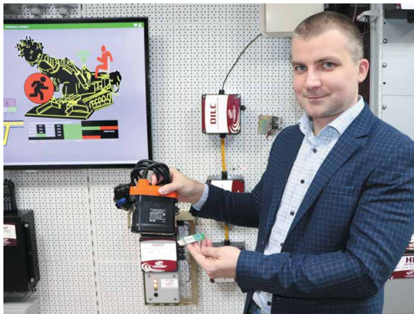
Модули системы блокировки смонтированы в систему позиционирования Flexcom
